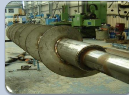
Fabricación de tornillo sin fin hélice derecha e izquierda
