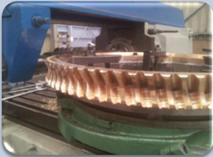
Fabricación de corona helicoidal, en bronce SAE 640
