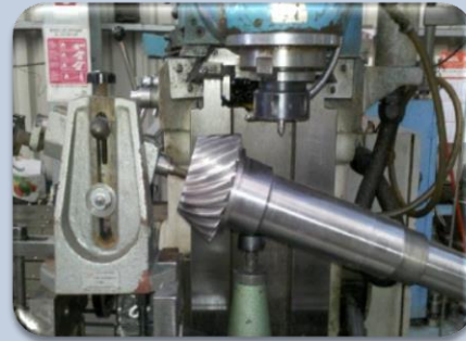
Fabricación de piñón cónico helicoidal
