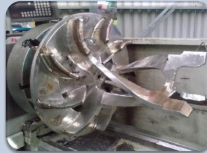
Recuperación impulsor de bomba
