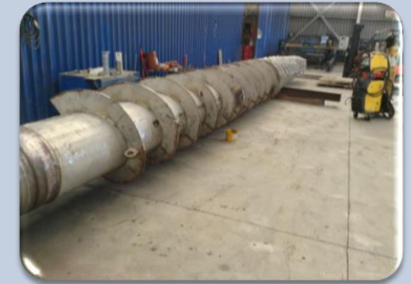
Reparación de Tornillo Recuperador de Corteza
